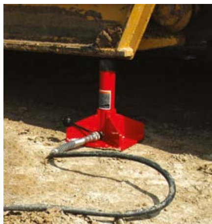
Cylinder jednostronnego działania H5513 w pozycji opuszczonej, gotowy do podnoszenia ładunku.
