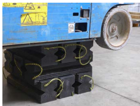
▲ Bloki stabilizacyjne zaprojektowano zgodnie z systemem bloków ryglujących. Na tym zdjęciu widzimy bloki SB 002B skonfigurowane do zastosowania jako 3-stopniowa kaszycza.
