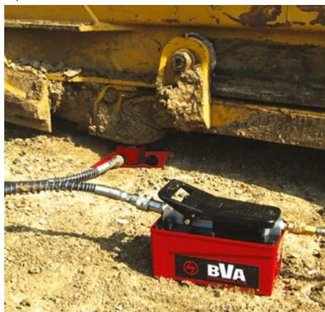
Model HF5006 w pozycji opuszczonej gotowy do podniesienia ładunku przy pomocy pompy nożnej PA1500.
