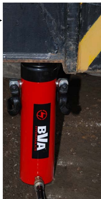
Cylinder jednostronnego działania H5513 w pozycji opuszczonej, gotowy do podnoszenia ładunku.
